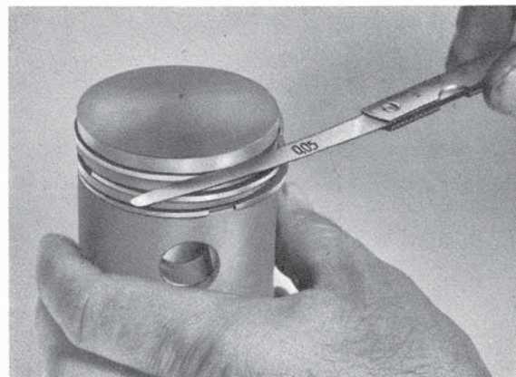
56 M Höhengspiel der Verdichtungsringe messen
