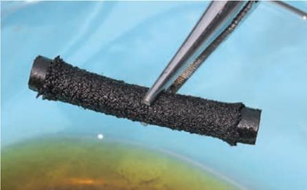
Geschrunpft: Der Textilmantelschlauch hat bei allen Proben gelitten, verwendbar wäre keines der Testexemplare mehr gewesen
