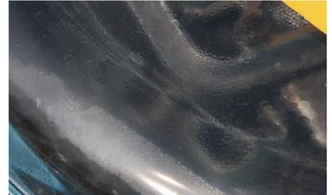
Kondensat im E-10-Ansatz: Bei den Proben mit Konservierungsmitteln trat dies nicht auf. Der Vergaser war allerdings frei von Korrosion
