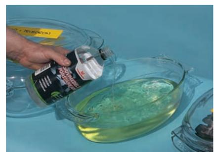
**...Unterschiede an den im Kraftstoff lagernden Vergasern ergeben. Die Additive werden exakt nach Mischungsvorschrift zugegeben**
