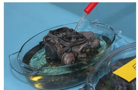
...aber seriöserweise nicht. Wir machen die Probe aufs Exempel und schicken Vergaser auf Tauchgang in verschiedene Kraftstoff-Rezepturen
