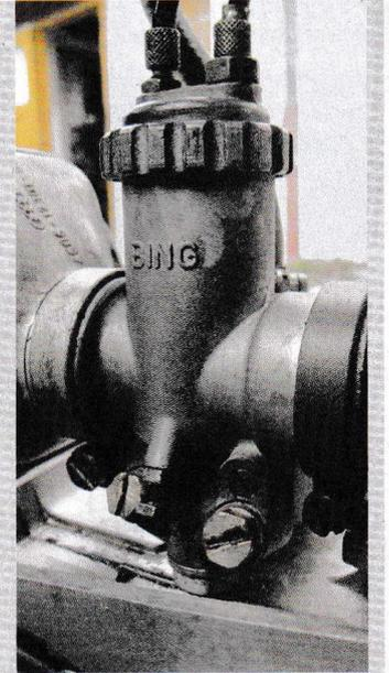
Nach dem Kauf: Düsengrößen checken sowie Düsennadel und Nadeldüse erneuern
