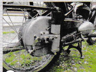
**11** Aluguss- und Blechteile des Kettenkastens sollten in gutem Zustand sein, Ersatz ist rar
