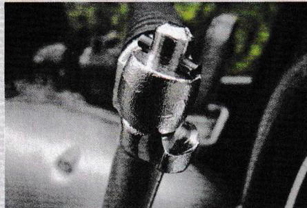
Werden zum Glück nachgefertigt: Oft sind die Kickstarter am ausklappbaren Pedal ausgeschlagen, gebrochen oder geschweißt
