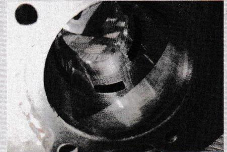
Zylinder und Kolben halten etwa 30.000 Kilometer bei sinniger Fahrweise, dann wird das nächste Schleifmaß fällig
