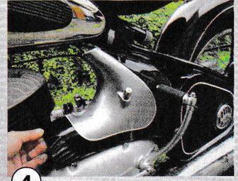
**4** Die Vergaserverkleidung ist aus Aluguss, der eine spezielle Grundierung benötigt
