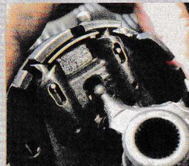
...verschlissen sein oder der Schaltfinger, der ins Schaltstück eingreift
