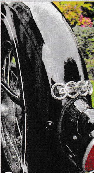
**7** Auch der hintere Kotflügel zeigt trotz eingeschweißten Kabelkanals eher selten Rostschäden
