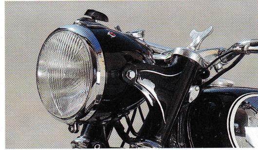
Standard nicht nur bei DKW: das karge Cockpit mit „Zündnagel“ und Kontrollleuchten im Scheinwerfergehäuse
