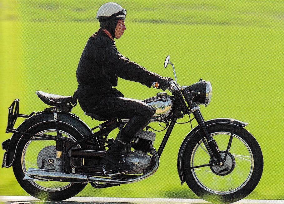
Mit Hinterradfederung: Nach nur 23 Exemplaren löste die RT 250 H die ursprüngliche RT 250 mit Starrrahmen ab
