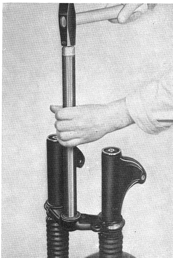
12 R Gabelaufring mit Treibhülse aufschlagen
