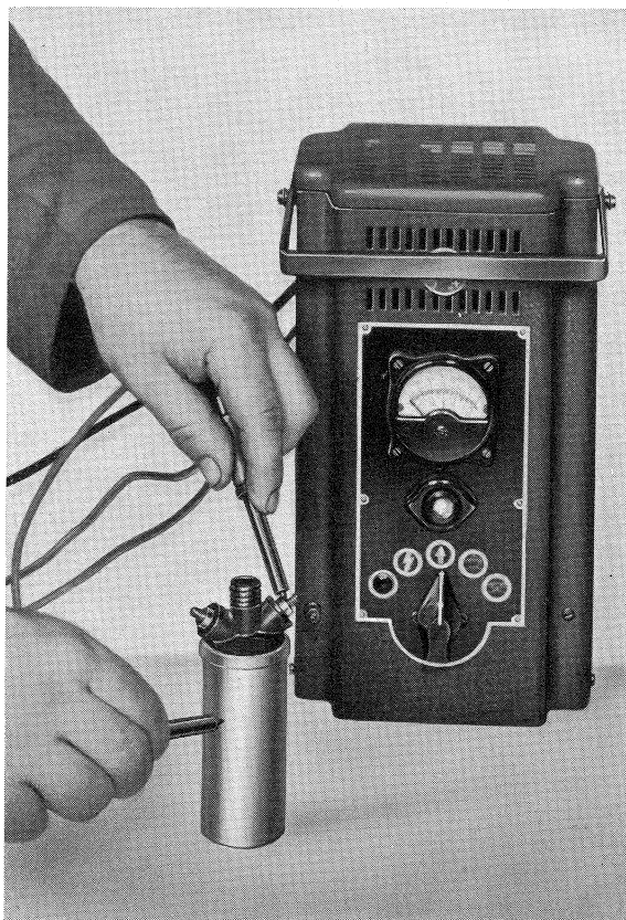
45 E Zündspule auf Masseschluß prüfen
