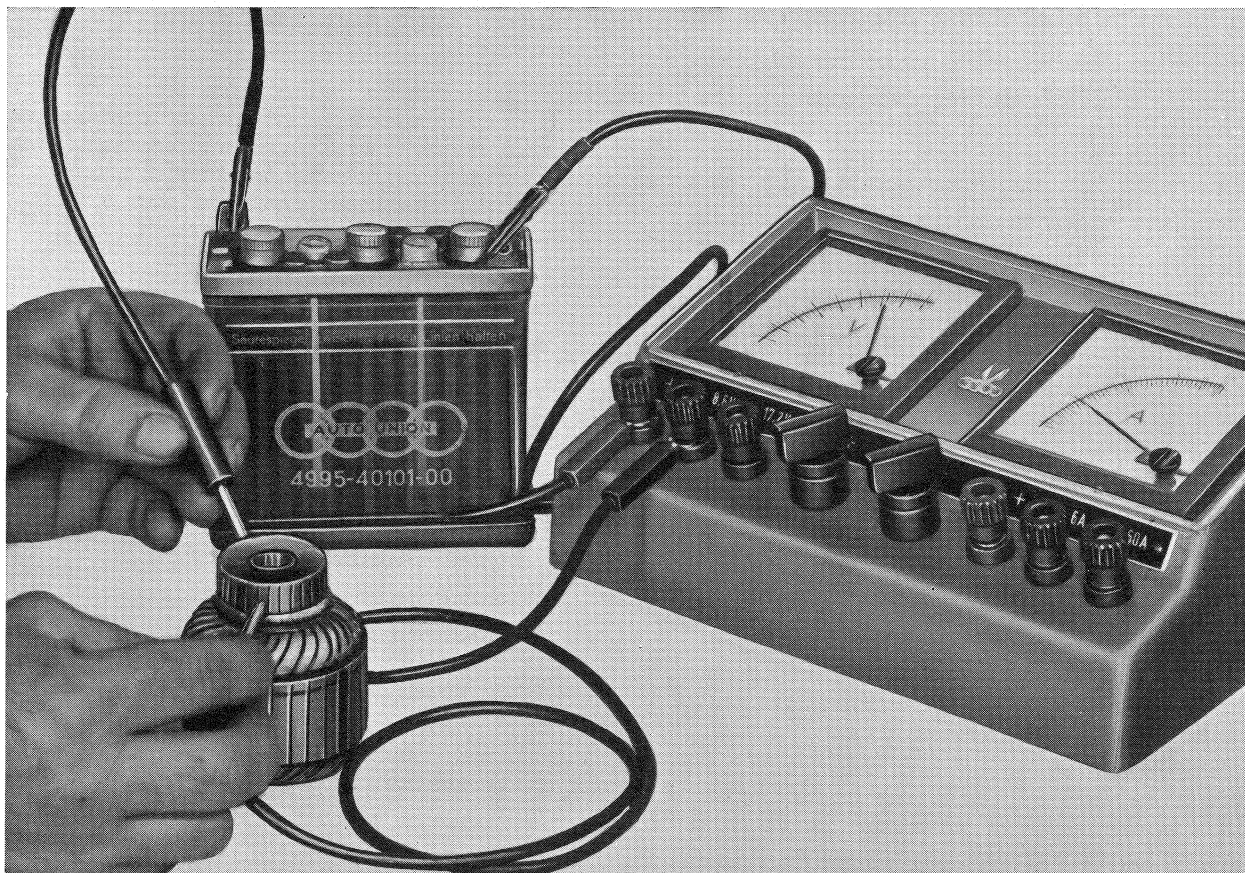
31 E Anker auf Durchgang prüfen
