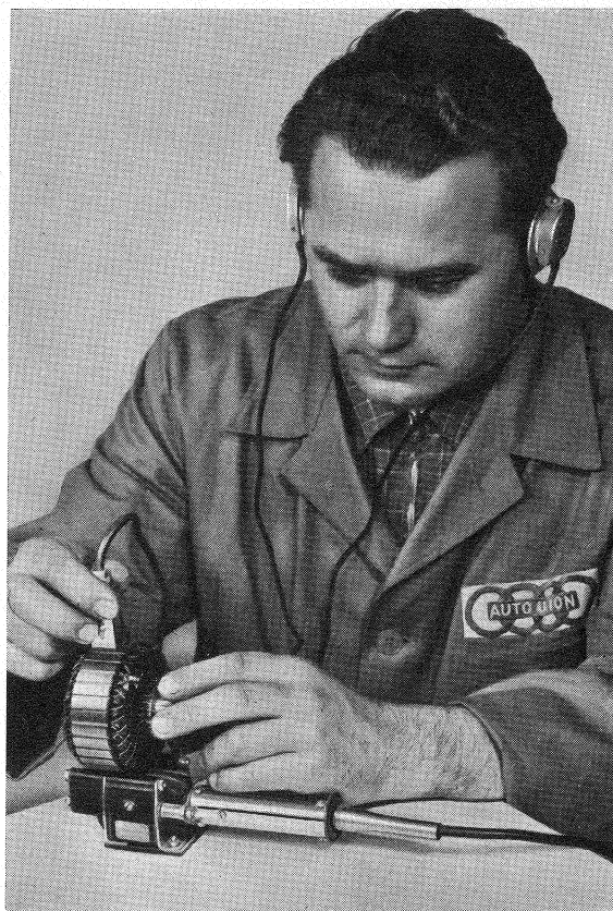
29 E Anker auf Spulenschluß prüfen (Abhorchgerät)
