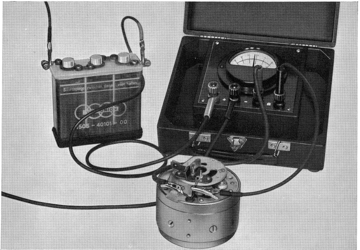
20 E Widerstand der Polwicklung mit Ohmmeter messen
