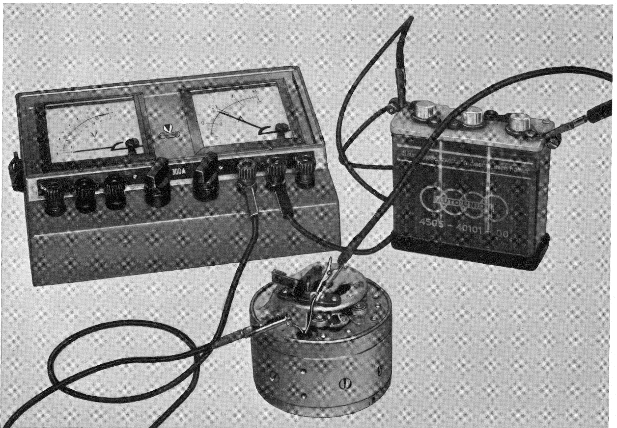
21 E Widerstand der Polwicklung mit Amperemeter messen
