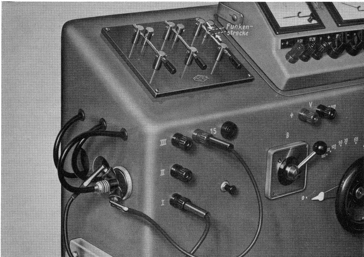
46 E Zündspulen auf DKW-Elektroprüfstand prüfen
